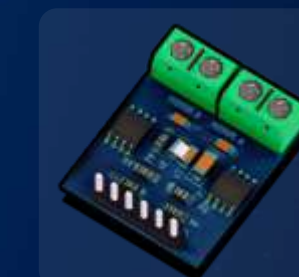
CONVERSOR PONTE H
