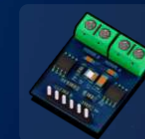
CONVERSOR PONTE H
