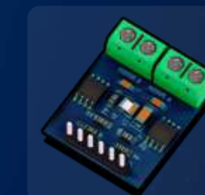
CONVERSOR PONTE H
