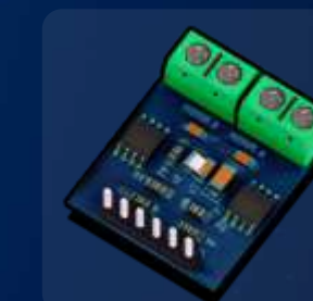
CONVERSOR PONTE H
